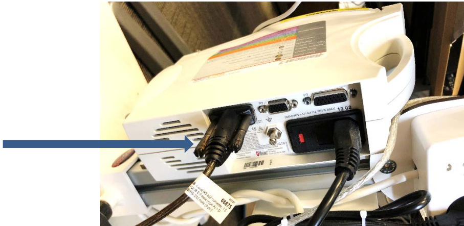
Figuur 5: vast draaien schroefjes naast kabel voor een goede aansluiting
