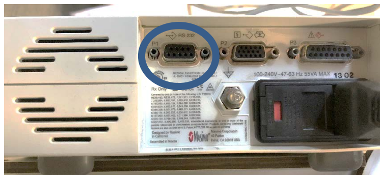
Figuur 4: aansluitpunten aan de achterkant van de saturatiemeter.
